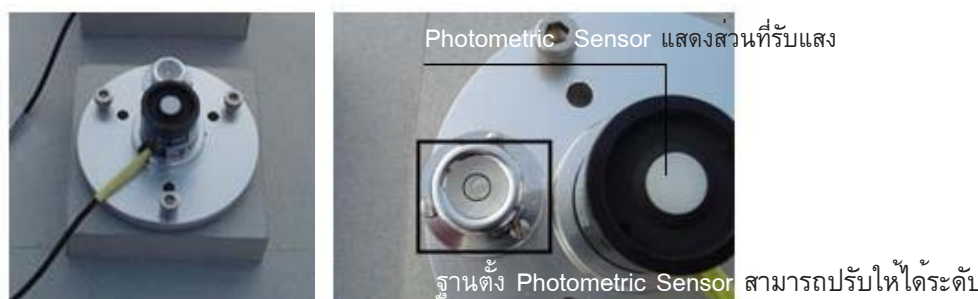
ภาพที่ 3 แสดงการติดตั้งหัวเซนเซอร์ ( Photometric Sensor ) ในการวัดค่าความส่องสว่าง พร้อมฐานปรับระดับ โดยการหมุนปรับระดับฟองอากาศให้อยู่ในกรอบวงกลมสีดำ
