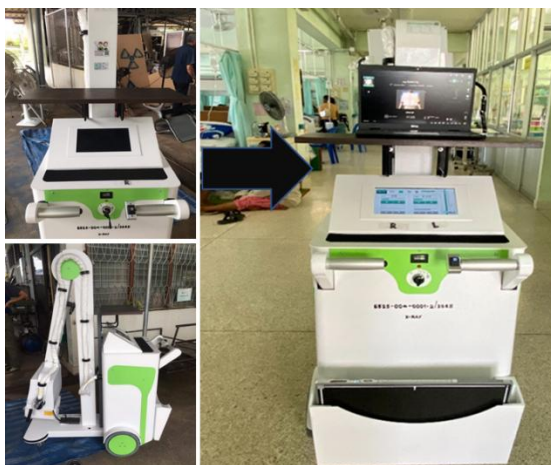
ภาพที่ 1 ระบบรับภาพในเครื่องเอกซเรย์เคลื่อนที่ทำการปรับจากระบบ CR เป็น DR ของ BMI
