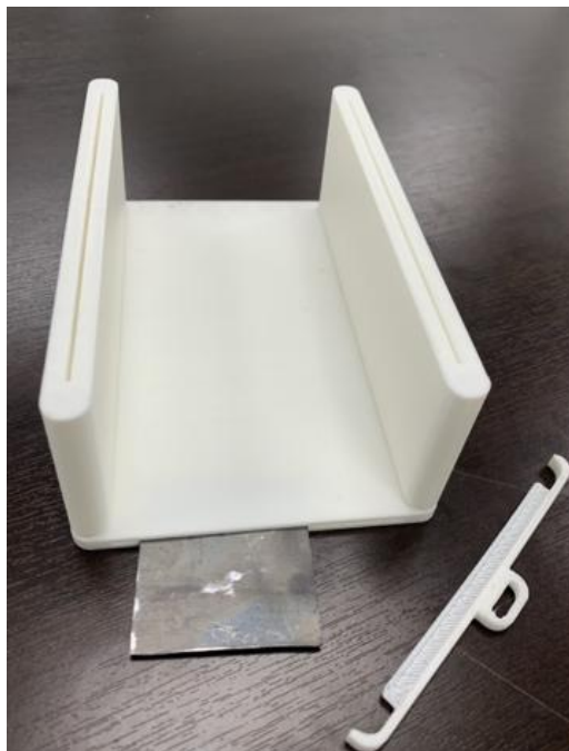
ภาพที่ 2 (ต้นแบบโมเดล 3 มิติ สำหรับใส่แผ่นตะกั่วความหนา 0.6 มิลลิเมตร)
