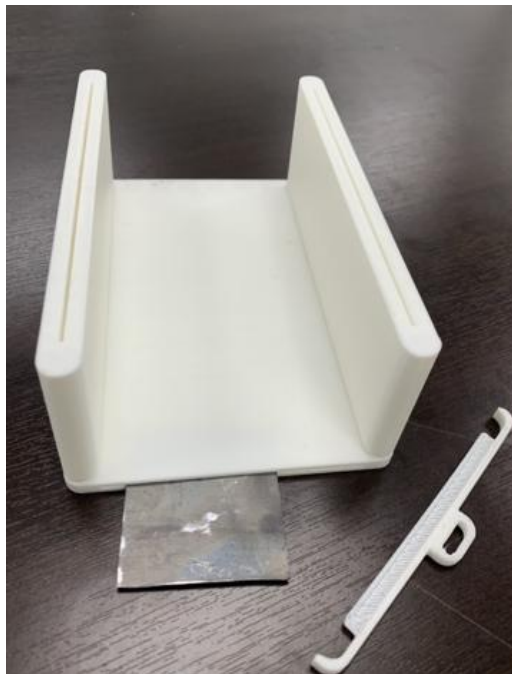
ภาพที่ 2 (ต้นแบบโมเดล 3 มิติ สำหรับใส่แผ่นตะกั่วความหนา 0.6 มิลลิเมตร)
