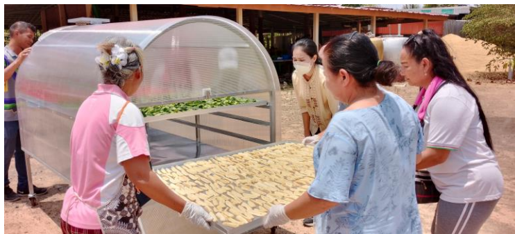
ภาพที่ 2 การถ่ายทอดความรู้จากงานวิจัยสู่ชุมชน : โดยทดลองการอบแห้งด้วยโดมอบแห้งพลังงานแสงอาทิตย์
