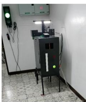
ภาพที่ 1 อุปกรณ์และขั้นตอนการทดสอบปฏิกิริยาเหยียบเบรก โดย (a) อุปกรณ์จำลองการขับขี่ที่ติดตั้งคันเร่งและเบรก และ (b) ตัวอย่างสัญญาณไฟจากสีเขียวเป็นสีแดงที่ใช้วัดความเร็วในการตอบสนอง
